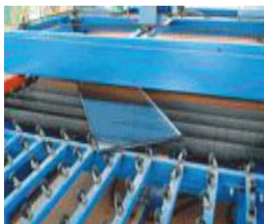
Sacar del horno termocompresor
