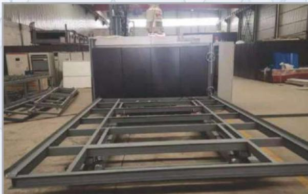
Horno de laminación de vidrio por medio de radiación de alta velocidad Laminación de PVB y EVA con ciclos rápidos para obtener altas y flexibles producciones a menor costo que con un sistema autoclave.
