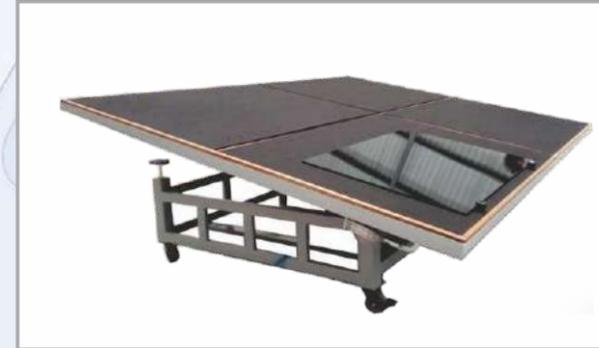
La mesa de corte manual SOLVITEC es una mesa con flujo de aire diseñada para el corte manual de láminas de vidrio. Este equipo cuenta con cilindros controlados neumáticamente por medio de pedales para inclinar la mesa entre las posiciones horizontal y vertical al igual que el sistema de partidores. Equipo robusto con colchón de aire, paño italiano y madera en MDF de alta calidad.
