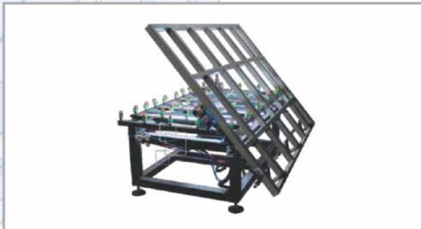
Estación trabajo auxiliar está diseñada principalmente para la alineación y combinación de vidrio, además puede ser usada como mesa de limpieza de vidrio cuando no se cuenta con una lavadora automática. El equipo se puede utilizar para resolver el problema del vidrio grande difícil de alinear en la producción de vidrio aislante, haciendo rodar el vidrio por una serie de romecas, para facilitar la alineación del segundo vidrio esta cuenta con unos topes para alinear los vidrios a 90°.
